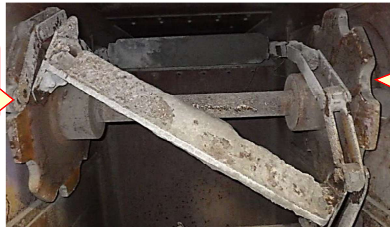
コンベヤチェーンが破断し、歯車から脱落
